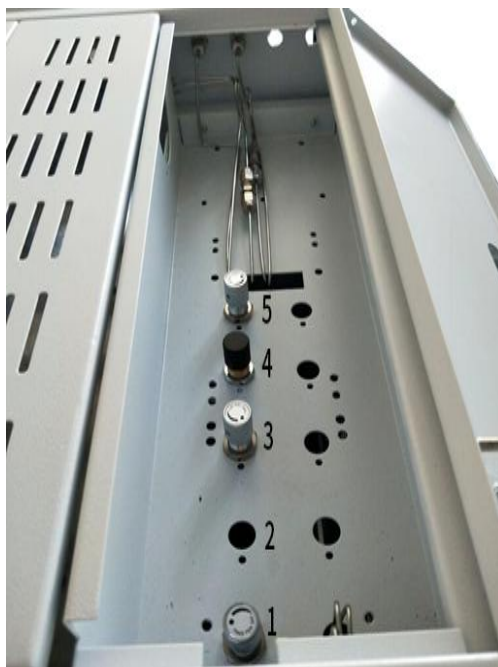
图8（图中1、2、3分别为载气针型阀、氢气针型阀、空气针型阀。4为背压阀，用来调节柱前压力，5为针型阀，用来调节隔膜流量。）
