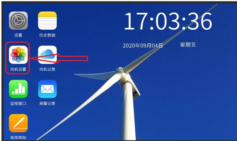
点击风机设置，根据现场实际需要设置风机启停时间，定时排风次数理论上可以设置 N 次，点击下面 x 或者+号进行设置
