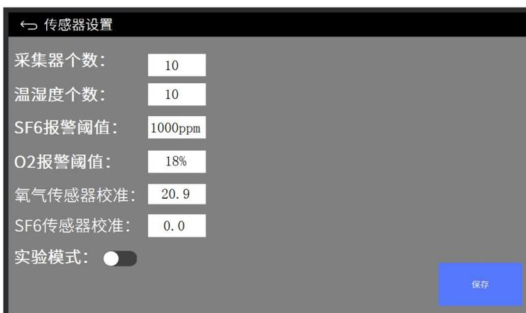
采集器个数、温湿度个数设置，根据现在安装数量进行设置，SF6 报警阈值，O2 氧气报警阈值出厂时已经按国家安规设置好，用户也可以根据实际情况进行设置。
