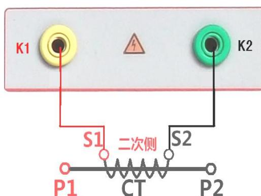
图 4, CT 励磁特性测试界面
