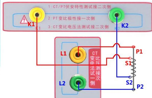
图 14, 电压法 CT 变比极性
