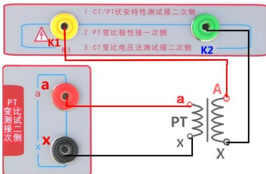
图 31, PT 变比极性（角差比差）接线图
