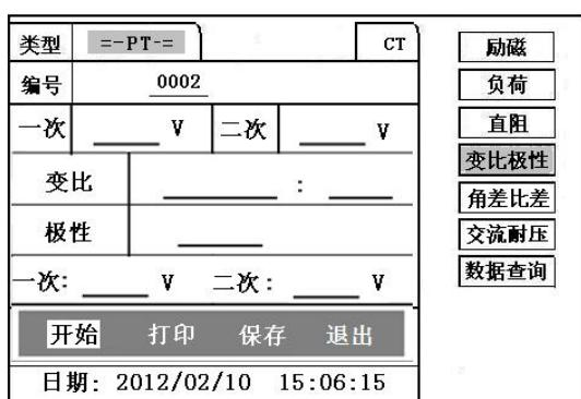
图 30, PT 变比极性测试界面
