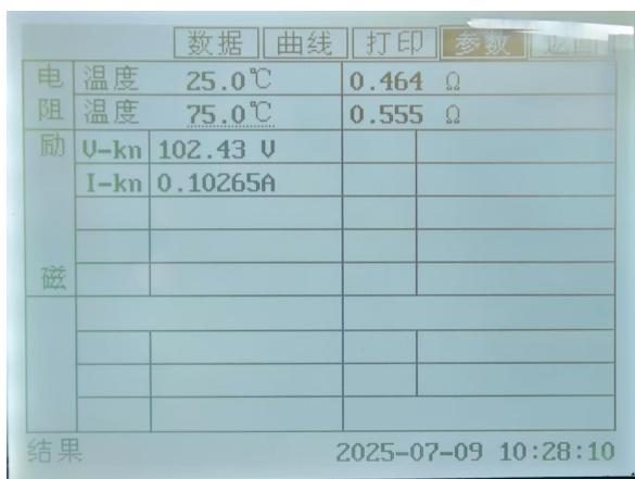
图 4.5 PT 电阻、励磁测试结果界面
