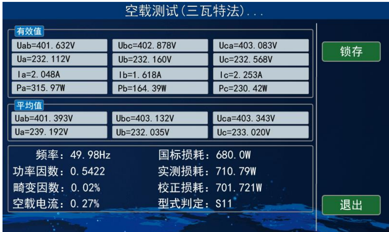
图 9-1 三瓦特法空载测试中
