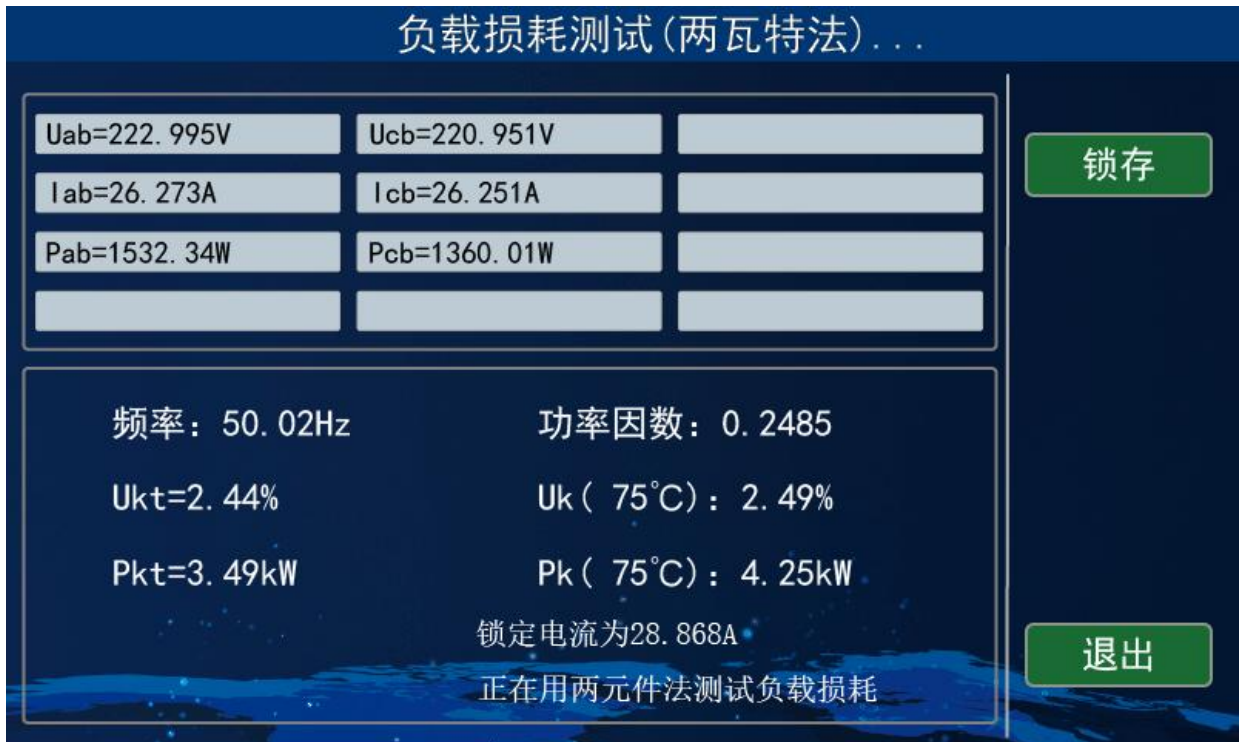
图 14-1 两瓦特法负载损耗测试
