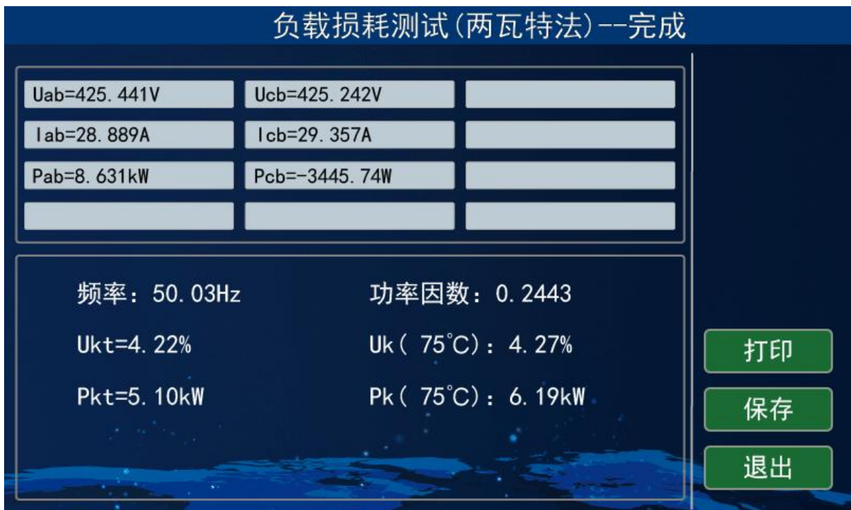
图 14-2 两瓦特法负载损耗测试结果
