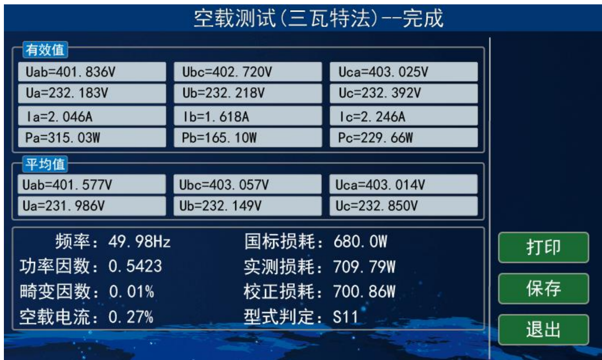
图 9-2 三瓦特法空载测试结果
