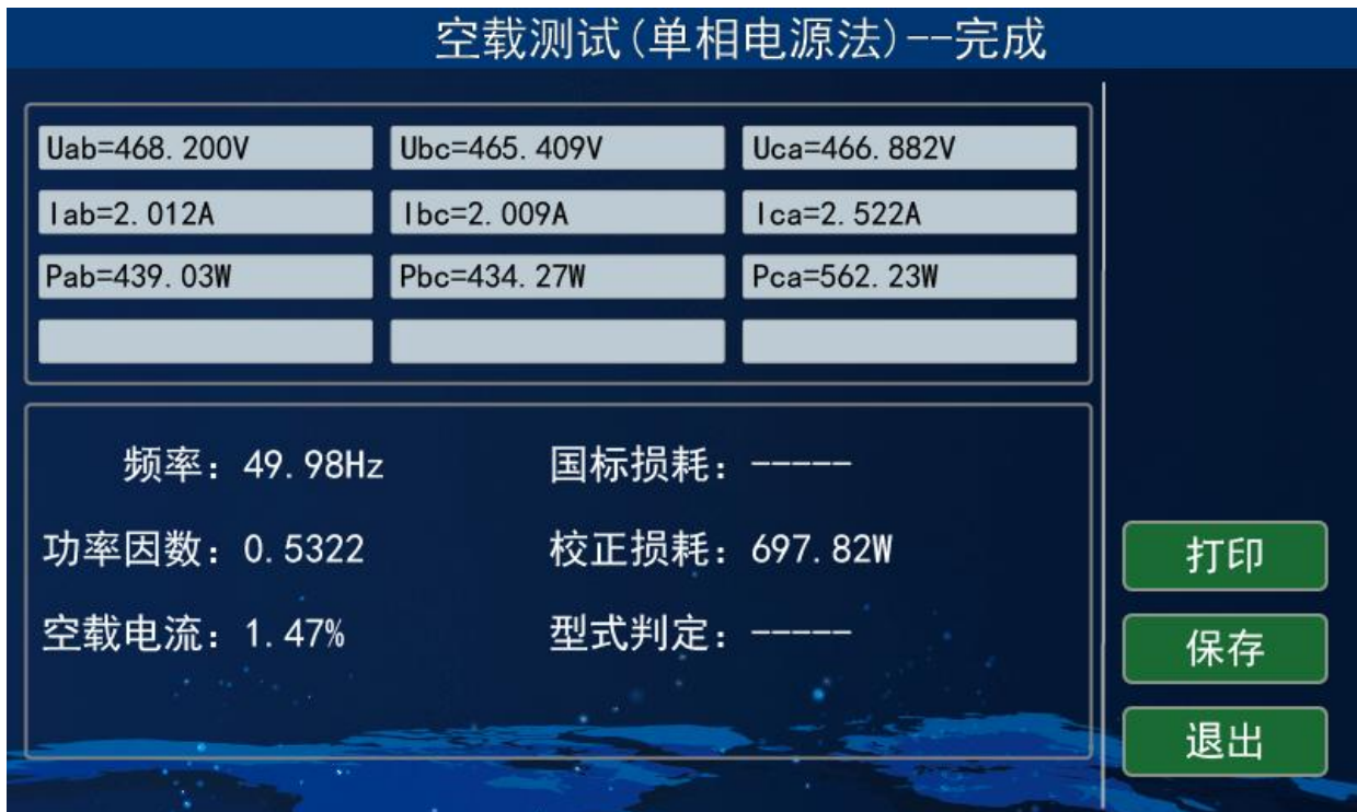
图 11-4 单相电源空载测试最终计算结果
