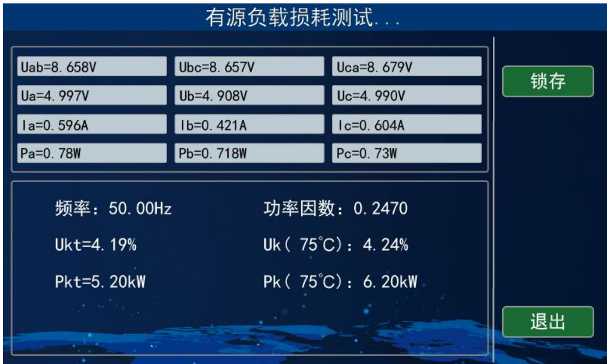
图 15-2 内置三相负载测试结果
