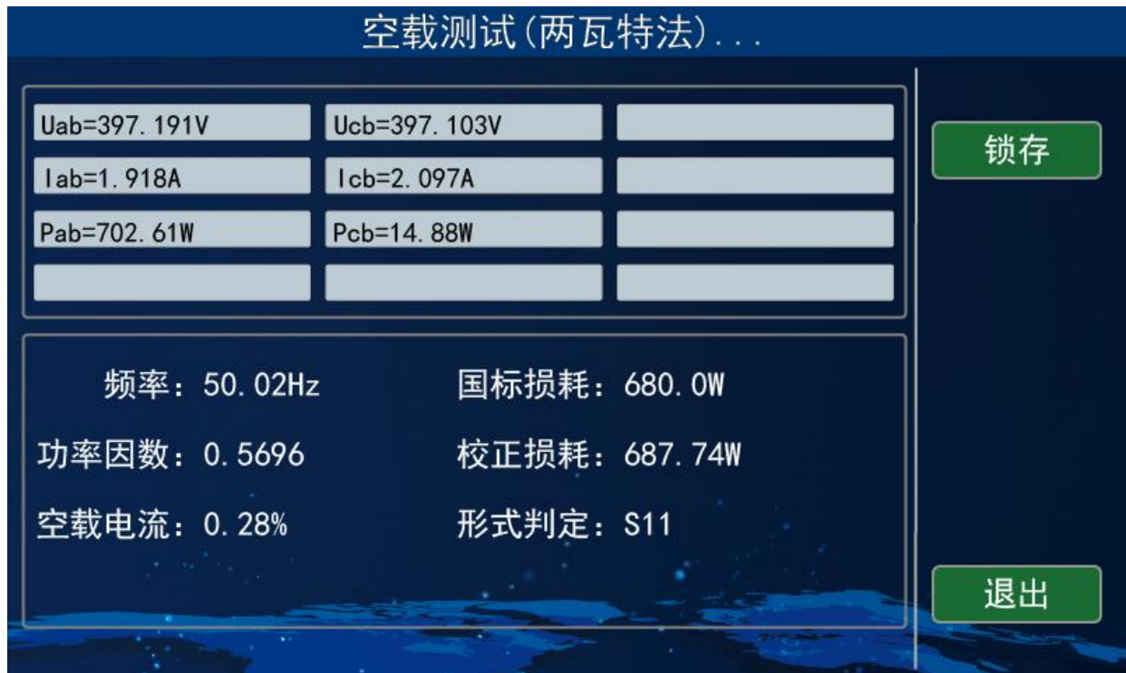
图 10-1 两瓦特法空载测试中
