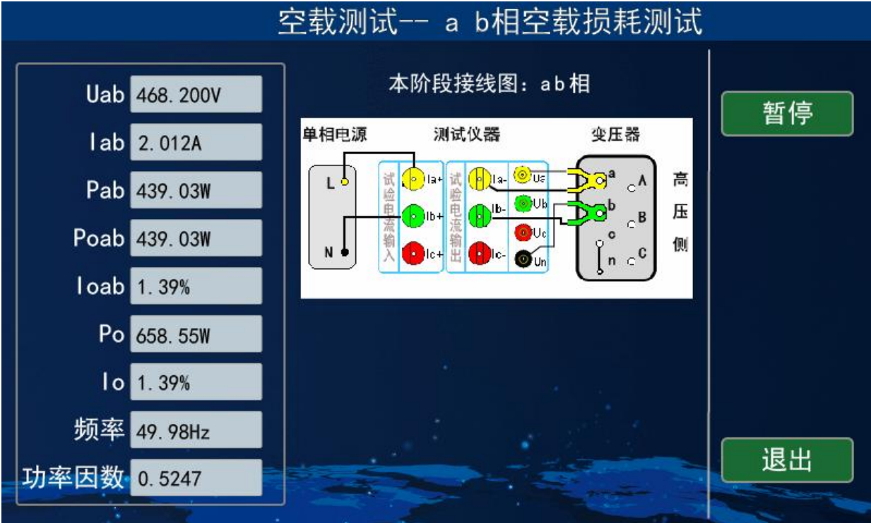
图 11-1 单相电源空载测试 AB 相
