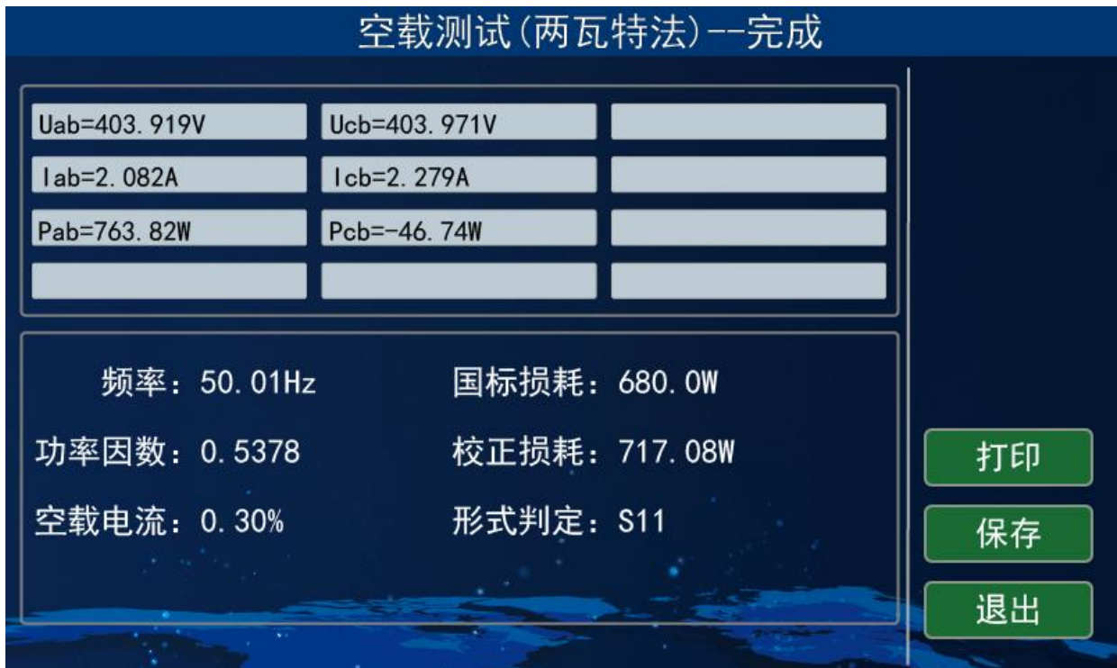
图 10-2 两瓦特法空载测试结果
