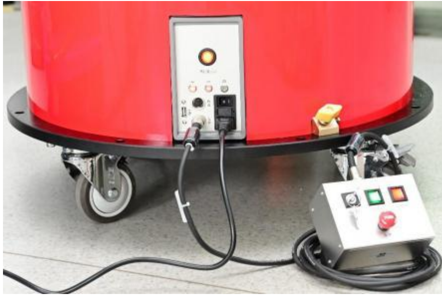
图 4-1 UHV-505 和外部安全控制单元连接
