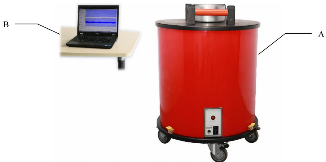
A、一体化阻尼振荡波单元 B、测控主机
