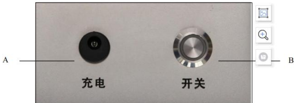
A、电池充电接口(9V 适配器) B、电源开关/指示灯
