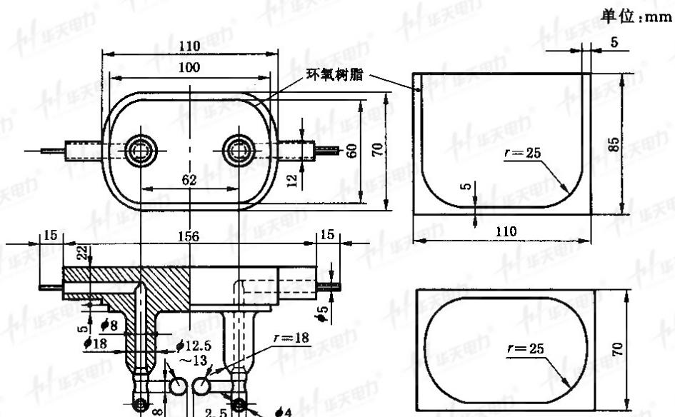
图 1 试样杯和球形电极
