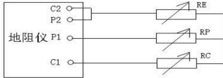
P1、P2—电压（电位）极端子；C1、C2—电流极端子；
