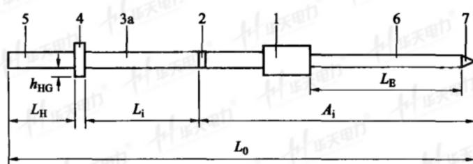
a) 有接触电极延长段的整体式验电器
