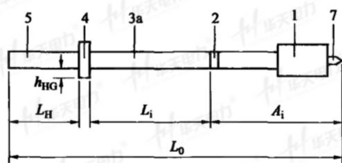
b) 无接触电极延长段的整体式验电器
