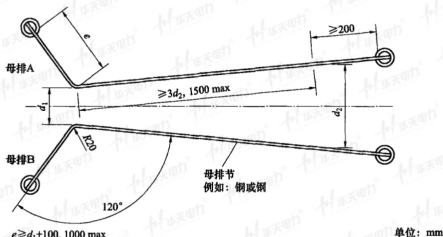
注: 母排截面为  $60\text{mm} \times 10\text{mm}$ , 母排所有边角均为半径  $1\text{mm}$  的圆角。
