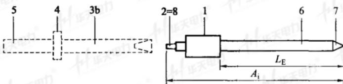
a) 有接触电极延长段的分体式验电器
