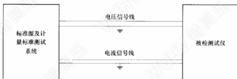
图 A.1 校验接线
