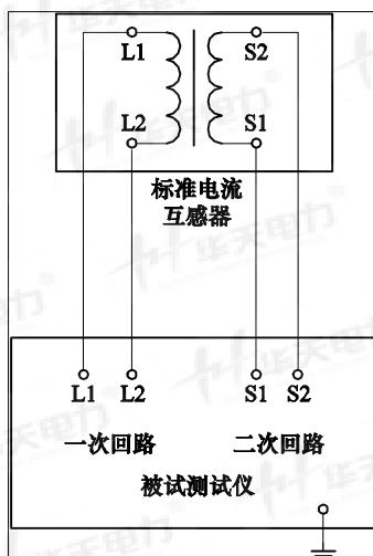
图 4 变比、极性试验原理接线图
