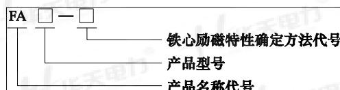
图 1 测试仪的型号命名规定
