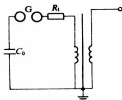
图 2 单相变压器试验接线图
