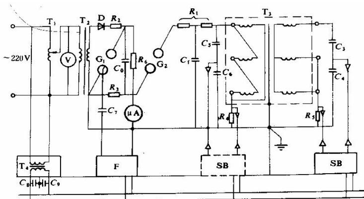
图 6 变压器操作波试验电路图
