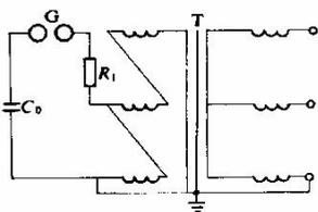
图 5 三相变压器中性点试验接线图
