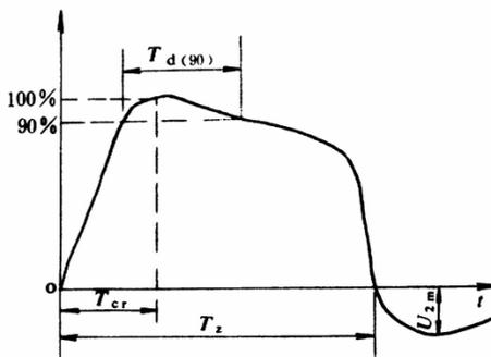
图 1 变压器操作冲击试验电压波形
