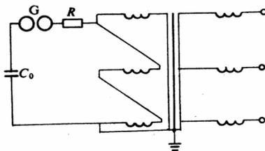
图 3 330、500kV 三相变压器试验接线图
