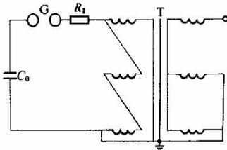
图 4 110kV、220kV 变压器试验接线图
