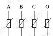
图 6 三相组合式避雷器结构示意图
