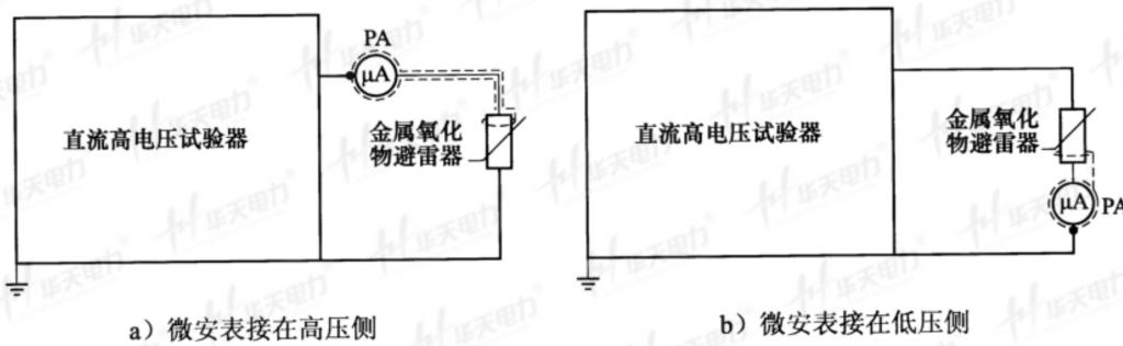
图 1 泄漏电流试验原理接线图
