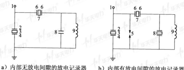
a) 内部无放电间隙的放电记录器 b) 内部有放电间隙的放电记录器
