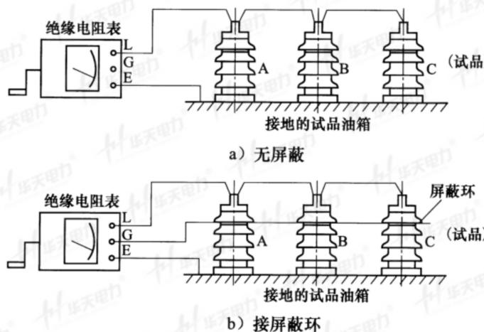
图 3 测量绝缘电阻时屏蔽环的位置
