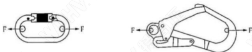
图C.5 连接器静负荷试验示意图
