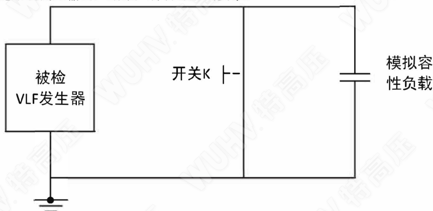
图4 短路保护功能试验接线示意图
