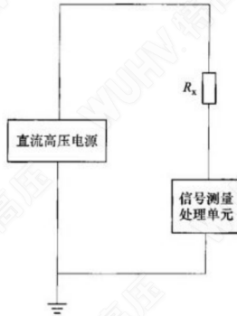
图3 体积电阻率测量原理示意图
