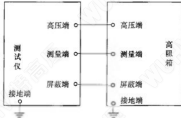
图 8 体积电阻率测量试验接线示意图
