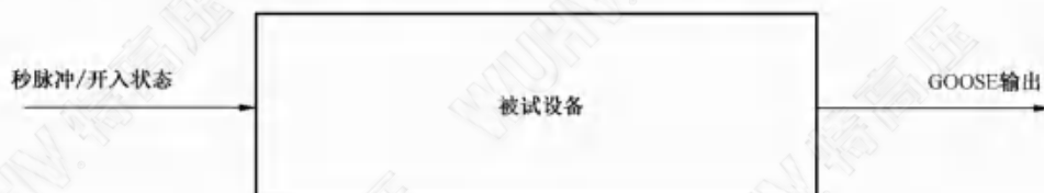
图 E.2 GOOSE 事件时间精度测试系统示例
