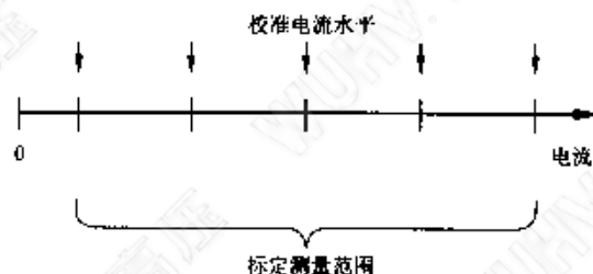
图 2 全电流范围内比对的校准
