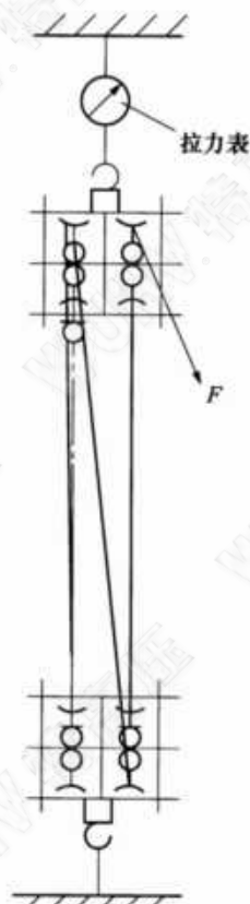
图 C.6 绝缘滑车机械试验布置图
