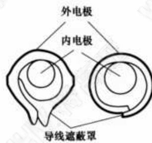
f) 软质导线耐压试验外电极
