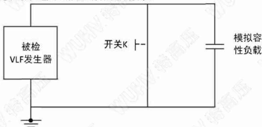
图4 短路保护功能试验接线示意图
