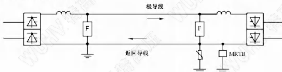
图 12 标明金属回路转换开关(MRTB)的单极金属回路系统
