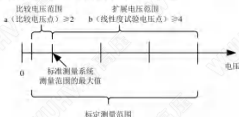
图 10 有限电压范围内刻度因数标定示意图
