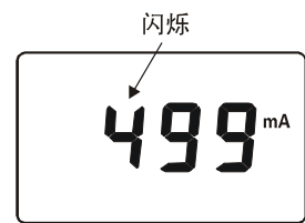
图14. 电流报警临界值设定
