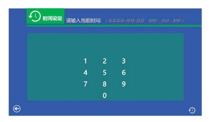
主菜单选择"修改时间"功能,进入时间修改页面。 根据上方的格式,输入当前的时间,按右下键时间修改按 钮,则修改完毕。按"←"箭头,取消修改,保留原时间 不变。
