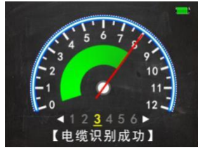
卡在目标电缆上绿色光栅 顺时针动态指示
