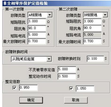
非全相零序保护定值校验对话框。包含第一次故障和第二次故障的设置，以及故障转换时间、不灵敏零序定值和整定动作时间等参数。
