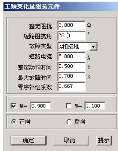
工频变化量阻抗元件对话框。包含整定阻抗、短路阻抗角、故障类型、短路电流、整定动作时间、最大故障时间、零序补偿系数等参数。
