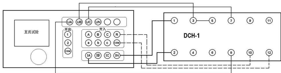
110V) 作电容充电电压， $U_c$  为 +110V。按下“确认”，“开始”输出 220V 电压。
