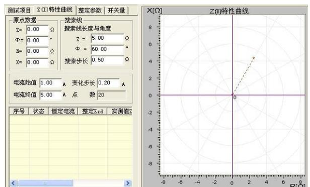
本试验的方法过程很像做差动继电器试验。如果把这里的阻抗比做差动试验的“制动电流”，则这里的电流就相当于“动作电流”。试验时，阻抗初始值为 0，按一定的搜索步长增加。测试在每一个阻抗值下，保护的動作電流。测试完毕，软件会自动绘制出相应的曲线。“Z(V)特性曲线”参照“Z(I)特性曲线”。
