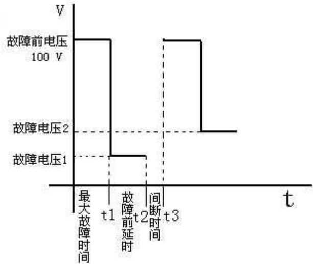
之后，测试仪再次输出正常的电压，并维持至“故障前电压”结束；后输出“故障电压 2”（变量变化了一个步长之后的电压），并维持至“最大故障时间”结束；后测试仪短暂停止输出（当“试验间断时间”不为 0 时）。如此循环输出。
