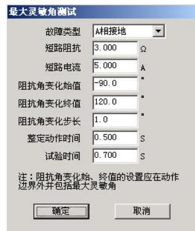
最大灵敏角测试对话框。包含故障类型、短路阻抗、短路电流、阻抗角变化始值、阻抗角变化终值、阻抗角变化步长、整定动作时间、试验时间等参数。
