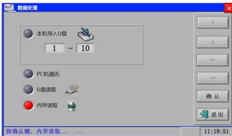
**本机导入U盘：**插入U盘，选择需要导出的数据，点击“确认”按钮，可将本机保存的数据导入U盘存储；
