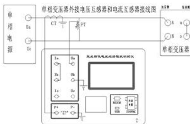
单相变压器外接 PT、CT 接线图
