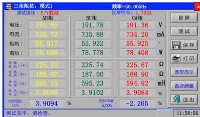
实时显示三相 (AB、BC、CA) 测量电压、电流、相角、有功功率以及计算的短路阻抗 (Zk)、短路电抗 (Xk)、绕组电感 (Lk)、阻抗电压 (Zke)；
