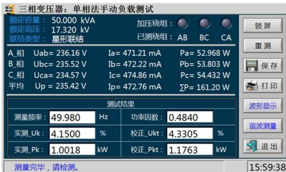
通过依次点击右上角的加压绕组依次测量 AB、BC、CA 三相绕组，然后综合计算三相负载损耗。
