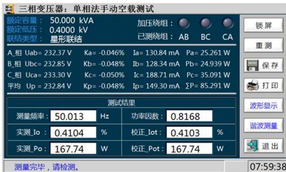
通过依次点击右上角的加压绕组依次测量 AB、BC、CA 三相绕组，然后综合计算三相空载损耗。
