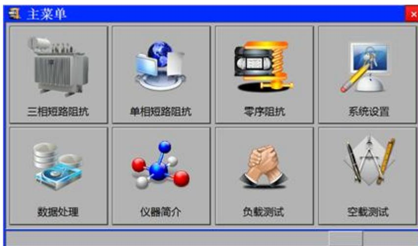
**三相短路阻抗：**用于三相短路阻抗测试的试品参数、用户测试参数设置；
