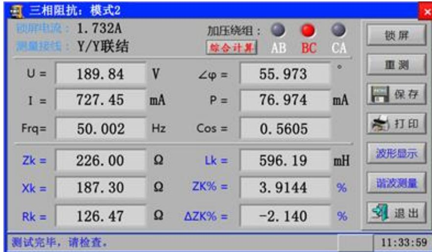
通过依次点击右上角的加压绕组依次测量 AB、BC、CA 三相绕组，然后点击“综合计算”按钮，计算三相短路阻抗。
