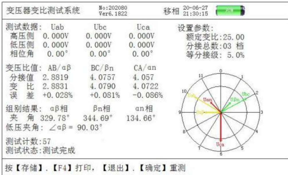
图十四、斯科特变压器测试结果屏
